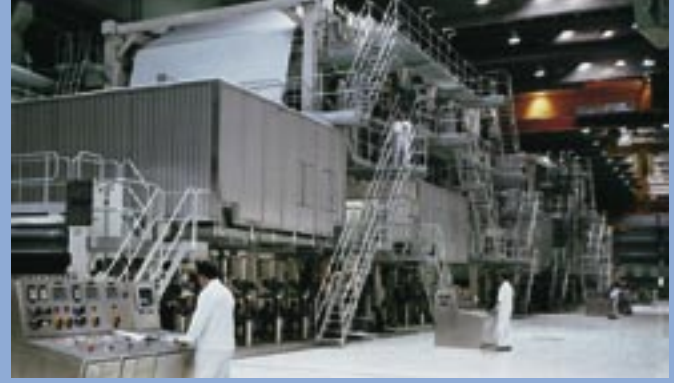
Die Technologie zur Papierherstellung ist sehr komplex: Unter anderem müssen Temperatur und Feuchtigkeitsgehalt des Papiers genau geregelt werden.
