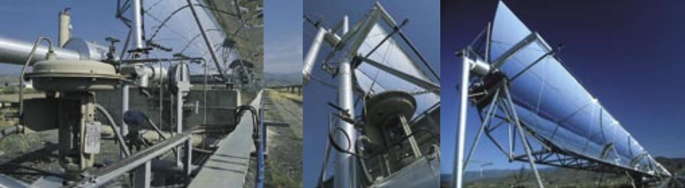
... Conduite en forme de tuyau, dans laquelle l'eau est surchauffée. Les vannes de régulation de SAMSON règlent le débit. A la suite de quoi, on produit de l'électricité via des turbines et des générateurs avec un degré d'efficacité remarquable - des perspectives solaires et ensoleillées!
