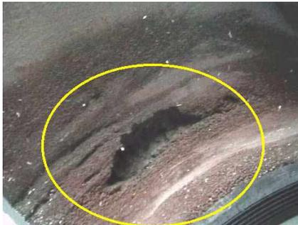
Bild 5: Gehäuseerosion eines Drehkegelventils durch Kavitation
