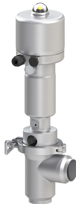
Компактное автоматическое устройство: угловой клапан Тип 3347 с пневматическим приводом Тип 3379 и позиционером Тип 3724
