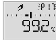
Si le positionneur n'est pas initialisé, il indique la position du palpeur dans la plage de fonctionnement -10 à +10 mm.
