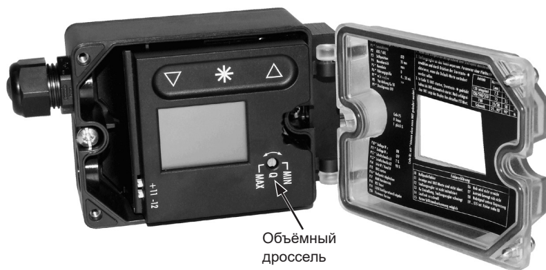
Рис. 20: Настройка дросселя расхода Q (положение MAX/MIN) (показано с крышкой устройства G1:00)
