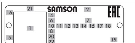
Fig. 1 : Position des informations sur la plaque signalétique de la vanne
