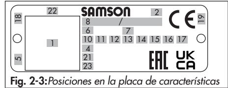
Fig. 2-3: Posiciones en la placa de características
