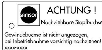
Bild 3: Schild bei nachziehbarer Stopfbuchspackung
