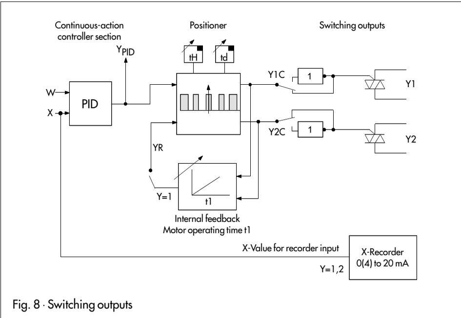
Fig. 8 · Switching outputs
