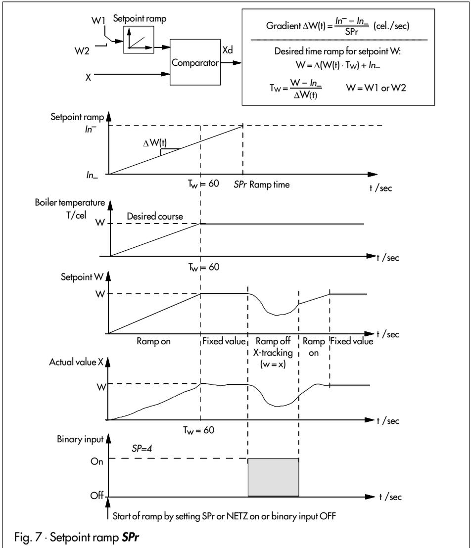
Fig. 7 · Setpoint ramp **SPr**
