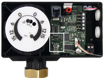
LEDs unter dem Gehäusefrontdeckel bei Ausführung 85 bis 264 V
